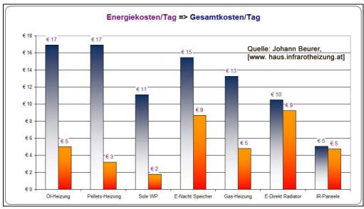
Auf der Basis des Gesamtaufwandes für den Bau und den 15-jährigen Betrieb von Heizanlagen ist die Wärmestrahlung mit Infrarot-Paneelen aus ökologischer und ökonomischer Sicht mit zu bevorzugen.
