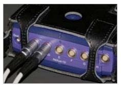
Biofeedbackgerät "Nexus 10" ist für die Auswertung spezieller Parameter der HRV ausgelegt.
